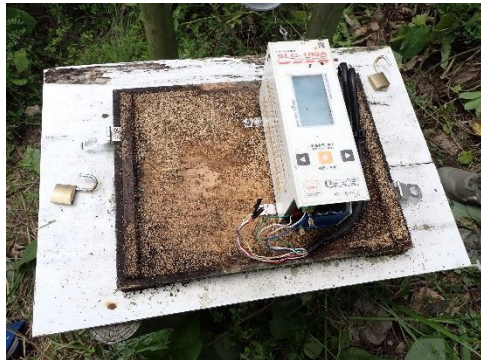
地盤伸縮計 HS-014 の架台の経年劣化
