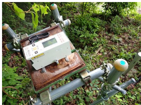
縦型伸縮計 YB-226-1 の架台の経年劣化
