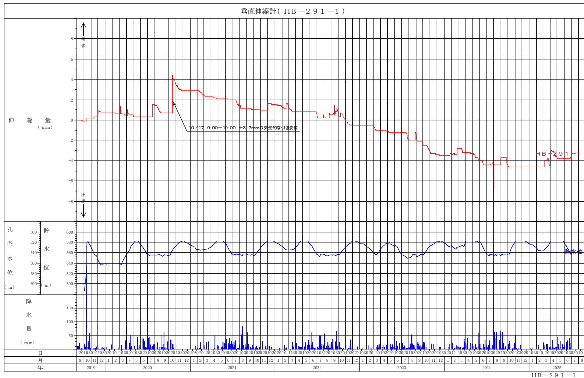
図 11.21 HB-291-1 垂直伸縮計変動図
