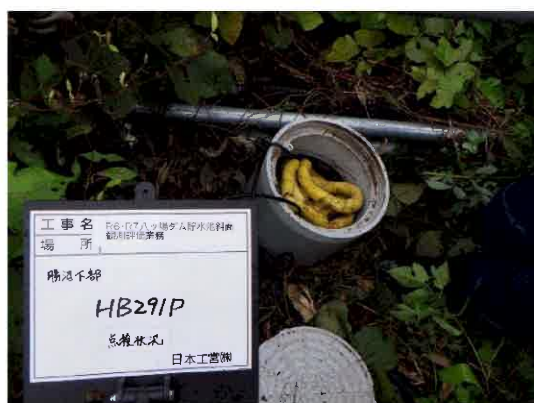
パイプ歪計 HB291P 保護管（塩ビ管）および内部塩ビ管が傾倒してぐらつく。
