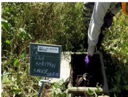
地下水位計 KHB198W 水位計の延長ケーブルに切断あり。
