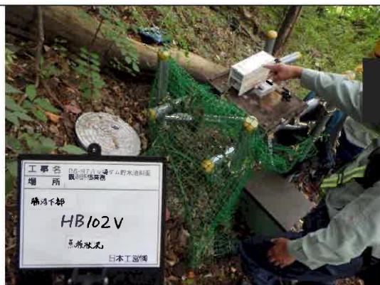
垂直伸縮計 HB102V マイナス側の測定範囲が 5mm しかない。
