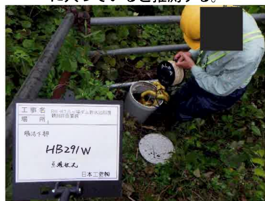
地下水位計 HB291W 保護管および内部塩ビ管が傾倒してぐらつきあり。水位検出部の絶縁抵抗値が低下している。
