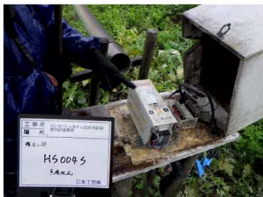
地盤伸縮計 HS004S 計器収納箱の、蝶番のネジが抜けている。
