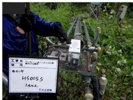
地盤伸縮計 HS005S 計器収納箱に、小動物にかじられた跡がある。
