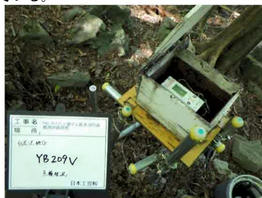
垂直伸縮計 YB209V 保護箱に害獣による軽微な損傷あり。
