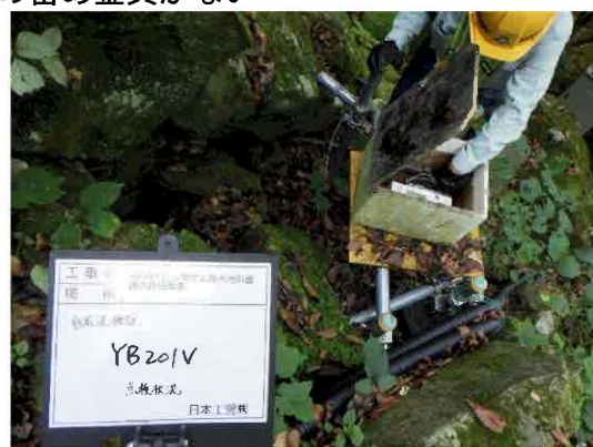
垂直伸縮計 YB201V インバー線が保護箱の通線用穴に当たっている。
