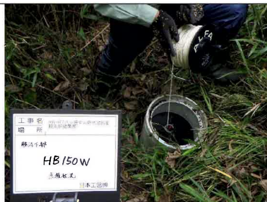
地下水位計 HB150W 水位計センサー部が塩ビ管内の堆積物内に入っていると推測する。
