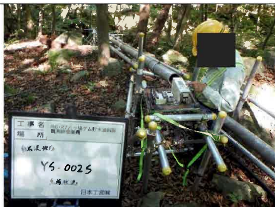
地盤伸縮計 YS002S 外部電源接続端子台にサビが発生、保護箱の留め金具がない
