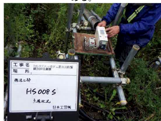
地盤伸縮計 HS008S 計器収納箱側板の腐食が進行している。 ロック金具が（左右2個）外れている。
