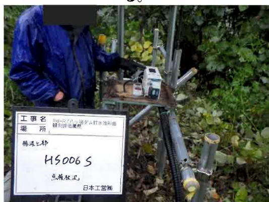
地盤伸縮計 HS006S 計器収納箱の、ロック金具が（左右2個）外れている。
