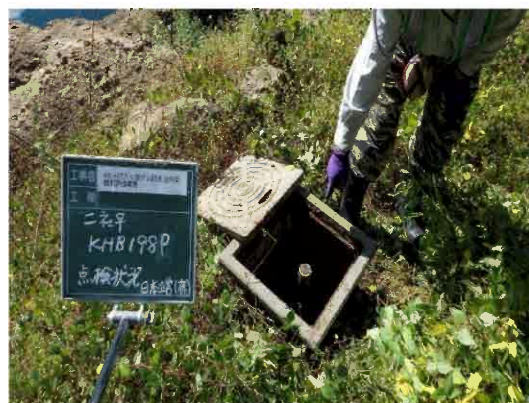
パイプ歪計 KHB198P CH50・CH54 のケーブルが切断。
