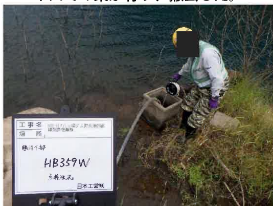
地下水位計 HB359W 水位検出部の絶縁抵抗値が低下している。
