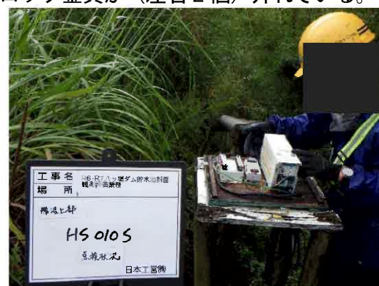
地盤伸縮計 HS010S 計器収納箱側板の腐食が進行している。
