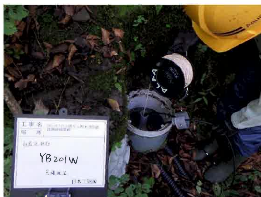
地下水位計 YB201W センサーケーブルが蓋で圧迫されている。センサーケーブルが中継ボックス側にひかれている。水位検出部の絶縁抵抗値が低下している。
