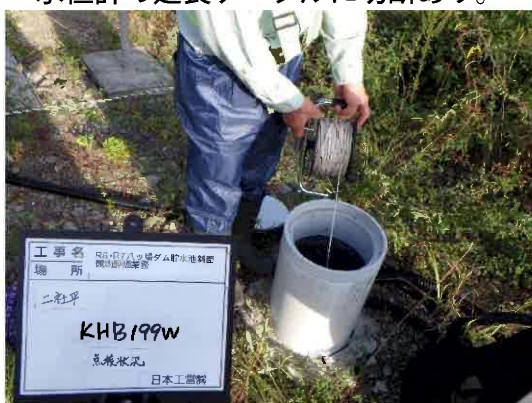
地下水位計 KHB199W 水位検出部の絶縁抵抗値が低下している。
