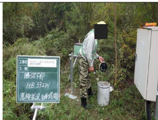
地下水位計 HB332W 水位検出部の絶縁抵抗値が低下している。
