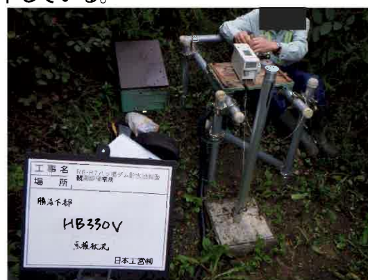
垂直伸縮計 HB330V ネズミの巣が有り、撤去した。
