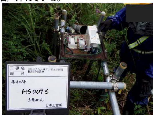
地盤伸縮計 HS009S 計器収納箱側板の腐食が進行している。 側板の腐食のため蝶番のネジが抜ける。
