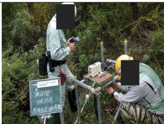
垂直伸縮計 HB332V ネズミの巣が有り、撤去した。
