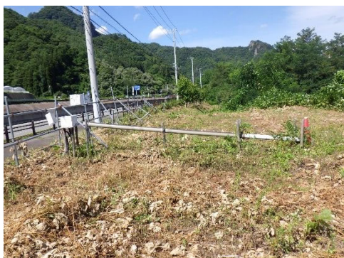
地盤伸縮計 HS-004 の架台の経年劣化
