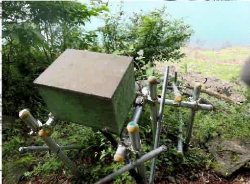
YB-260-1 縦型伸縮計の保護管及び保護箱に経年劣化が認められるため、再設置が必要である。
