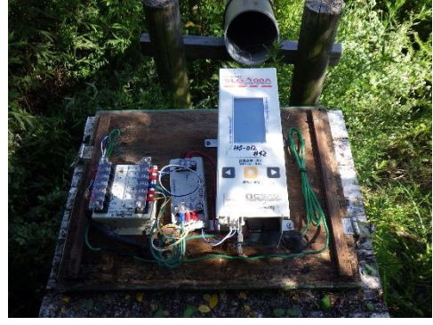
地盤伸縮計 HS-012 の架台の経年劣化
