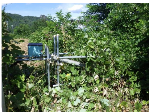
地盤伸縮計 HS-006 収納箱の破損
