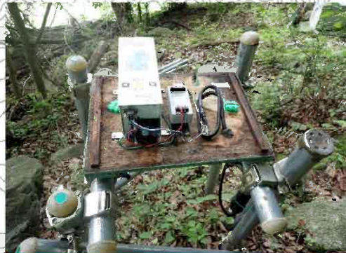
YB-232-1 縦型伸縮計の保護箱に経年劣化が認められるため、再設置が必要である。
