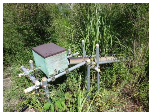
地盤伸縮計 HS-008 収納箱の破損
