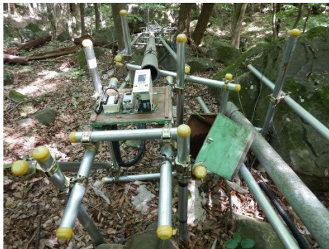
地盤伸縮計 YS-002 の架台の経年劣化
