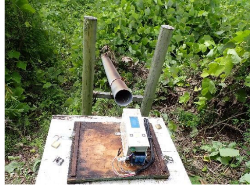
地盤伸縮計 HS-014 の架台の経年劣化
