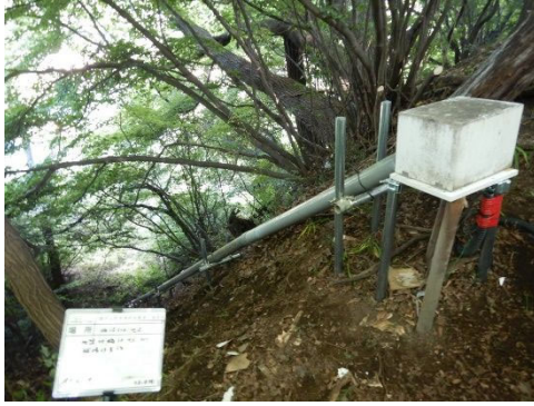
地盤伸縮計 HS-011 の収納箱の経年劣化
