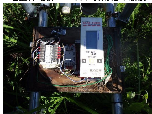
地盤伸縮計 HS-009 の収納箱の破損
