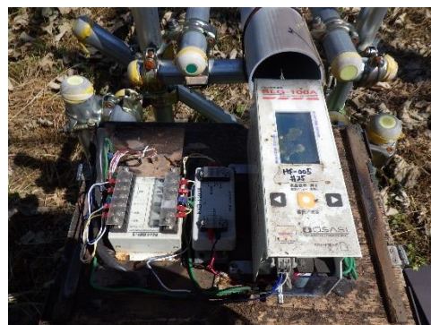
地盤伸縮計 HS-005 納箱の破損
