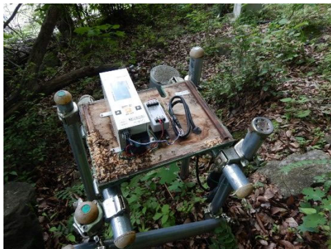
伸縮計 YB-232-1 の架台の経年劣化
