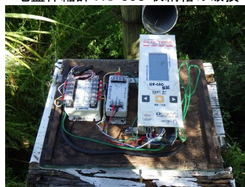
地盤伸縮計 HS-010 の架台の経年劣化
