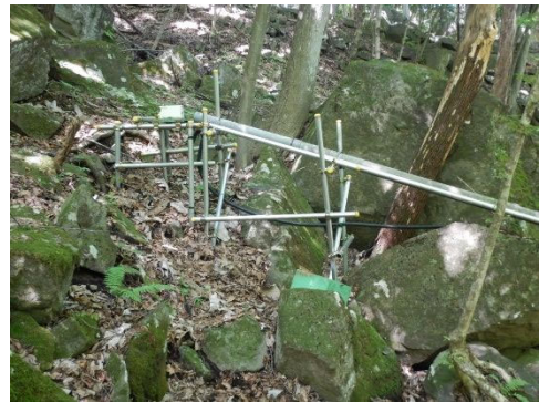
地盤伸縮計 YS-003 の架台の経年劣化
