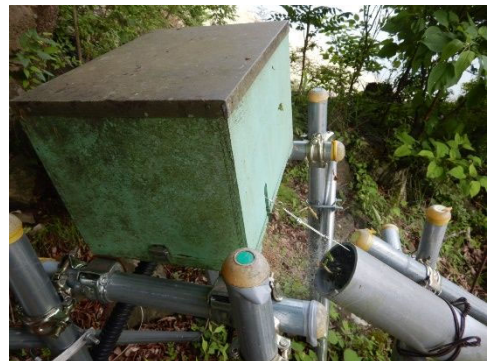
伸縮計 YB-260-1 の架台の経年劣化
