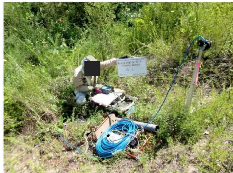
孔番号: BV-1 孔内傾斜計(手ばかり)
