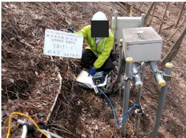
孔番号：YB191-1 孔内傾斜計(手ばかり)
