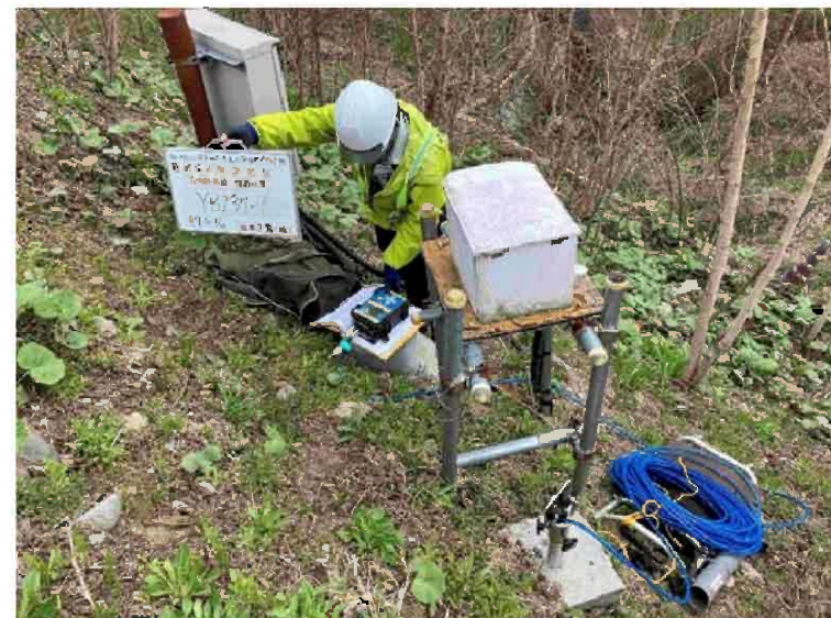
孔番号: YB237-1 孔内傾斜計(手ばかり)
