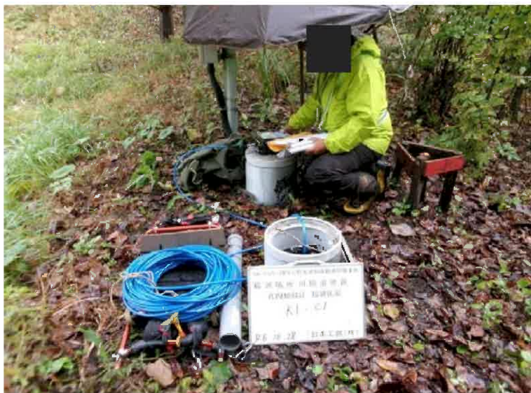
孔番号: KY-C1 孔内傾斜計(手ばかり)
