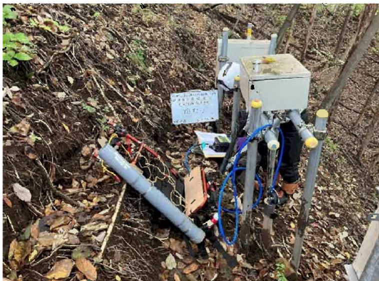
孔番号: YB191-1 孔内傾斜計(手ばかり)
