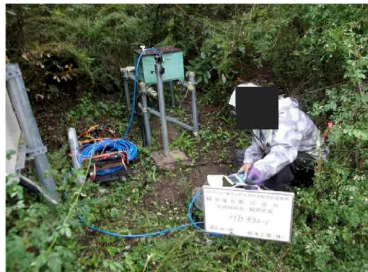
孔番号: HB330-1 孔内傾斜計(手ばかり)
