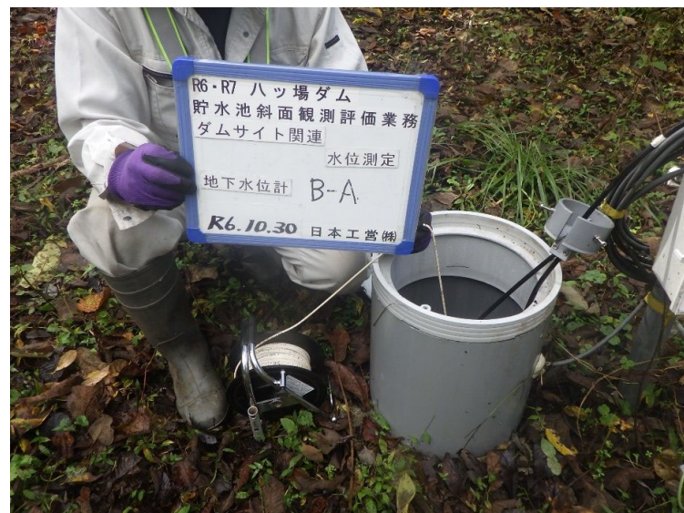
孔番号：B-A 地下水水位計（手ばかり）
