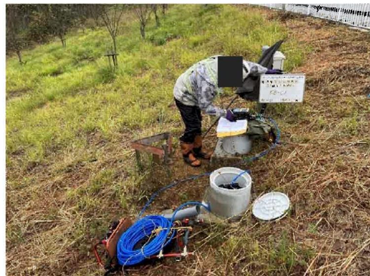
孔番号: KB-C1 孔内傾斜計(手ばかり)
