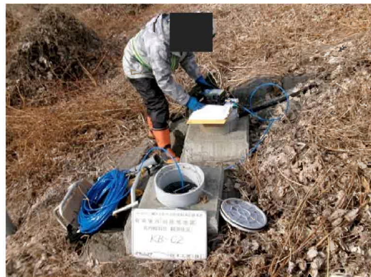
孔番号: KB-C2 孔内傾斜計(手ばかり)
