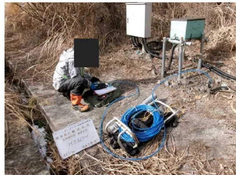
孔番号: HB329-1 孔内傾斜計(手ばかり)
