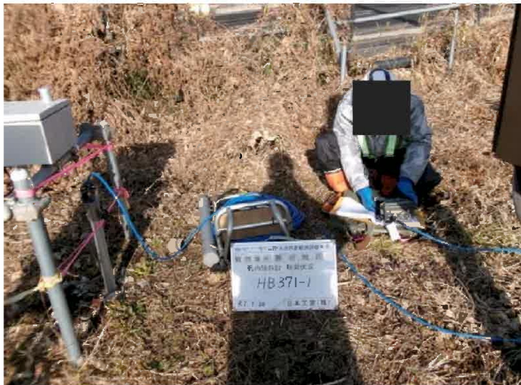
孔番号: HB371-1 孔内傾斜計(手ばかり)
