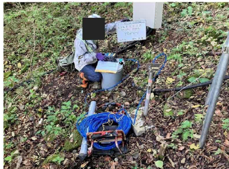
孔番号: YB212-1 孔内傾斜計(手ばかり)
