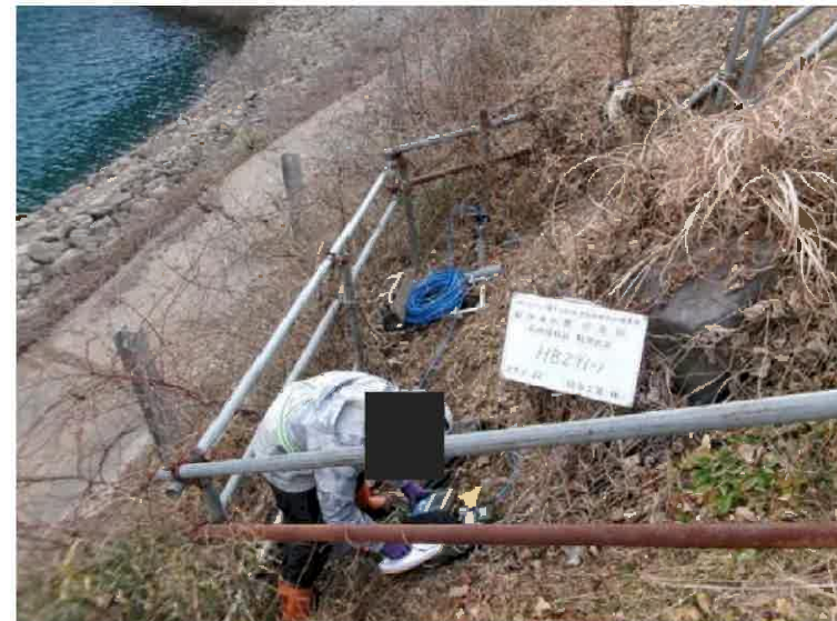
孔番号: HB291-1 孔内傾斜計(手ばかり)
