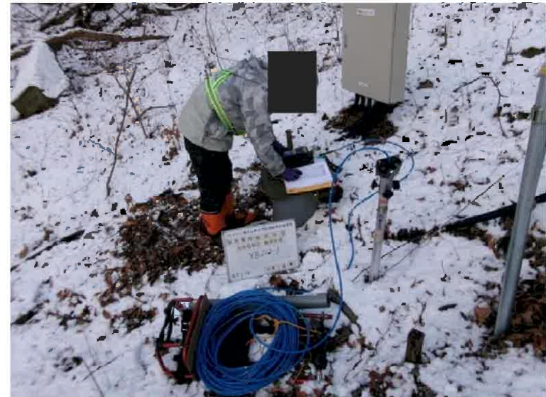
孔番号: YB212-1 孔内傾斜計(手ばかり)
