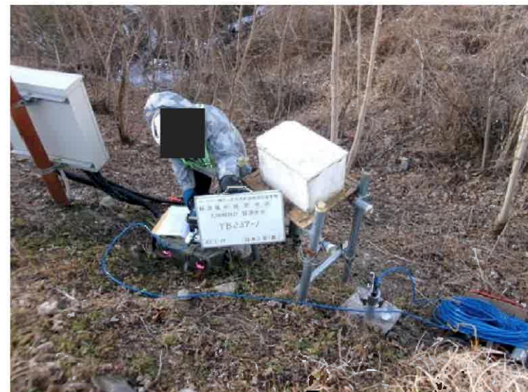
孔 番 号 : YB237-1 孔内傾斜計(手ばかり)
