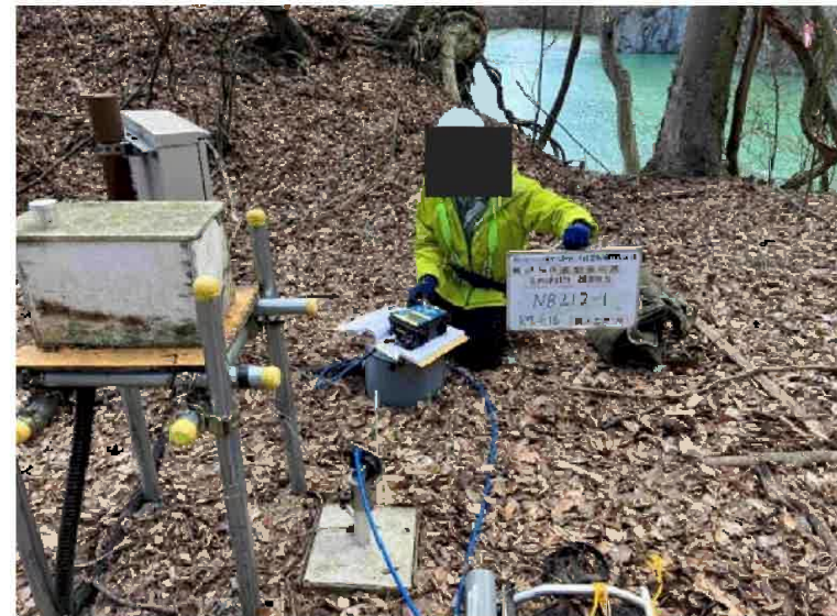
孔番号: NB212-1 孔内傾斜計(手ばかり)
