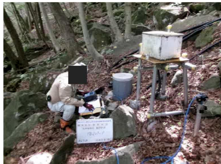
孔番号: YB209-1 孔内傾斜計(手ばかり)
