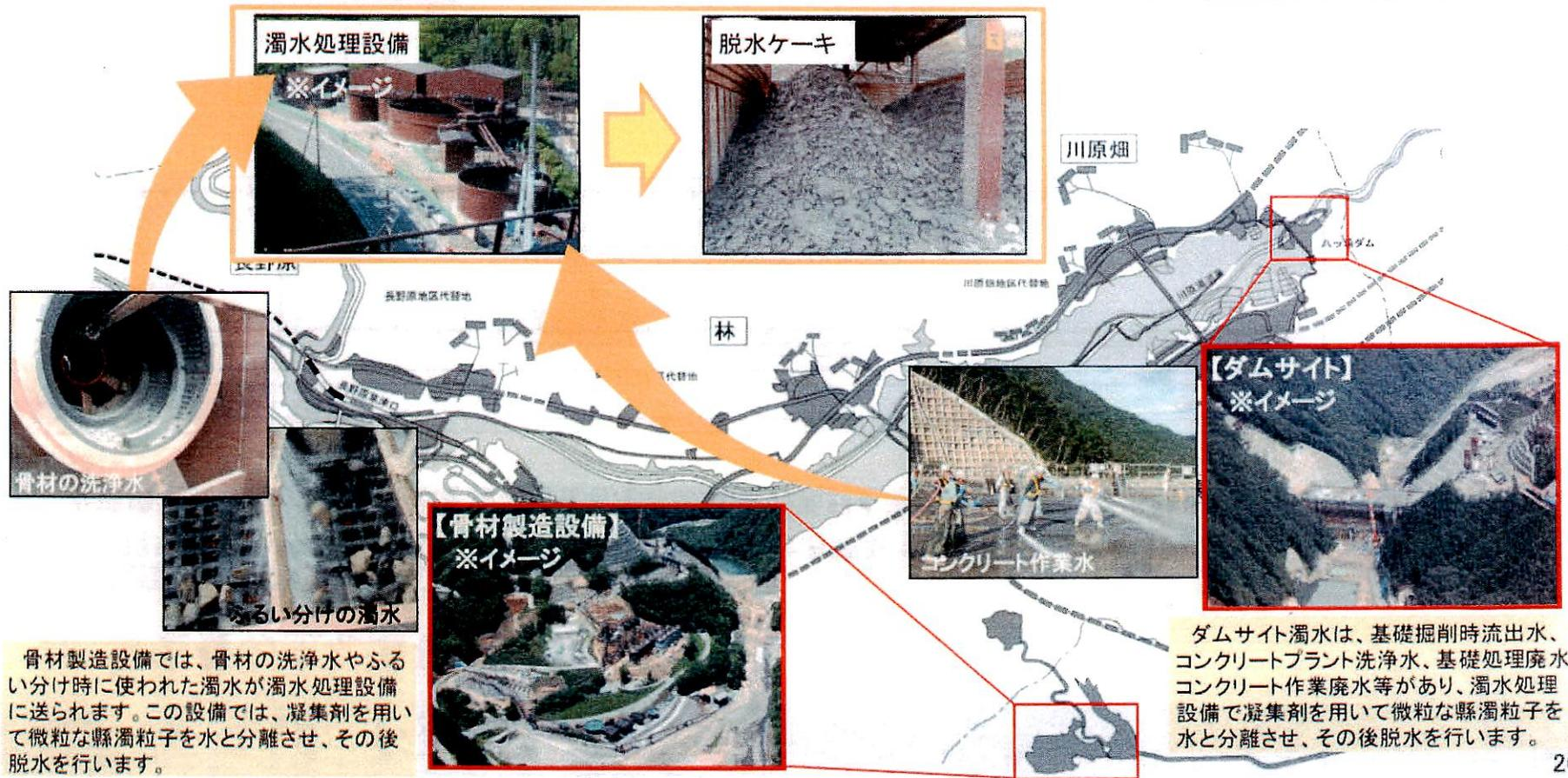
骨材製造設備では、骨材の洗浄水やふるい分け時に使われた濁水が濁水処理設備に送られます。この設備では、凝集剤を用いて微粒な懸濁粒子を水と分離させ、その後脱水を行います。
