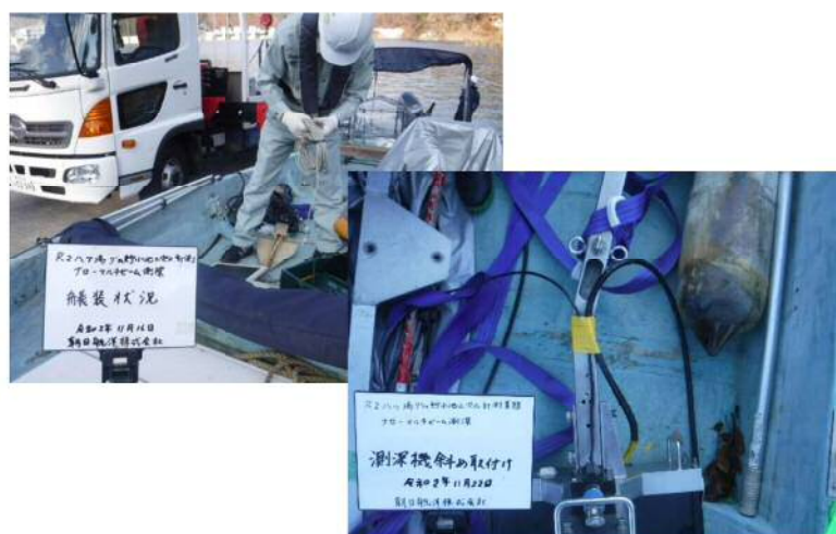
図 3-4-1-3 測量船の艀装状況
