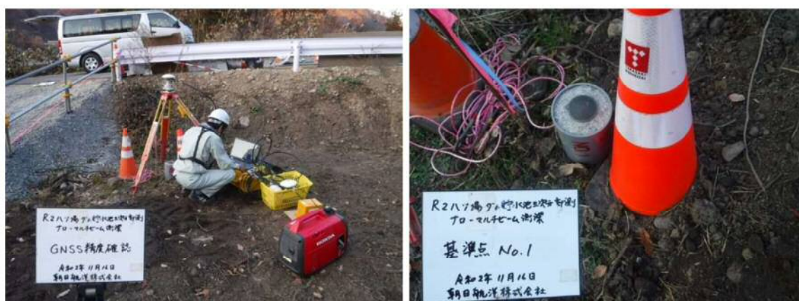
図 3-4-1-5 GNSS 精度確認状況
