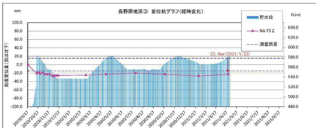
図 6.75 変位杭 NA-T3 変動図
