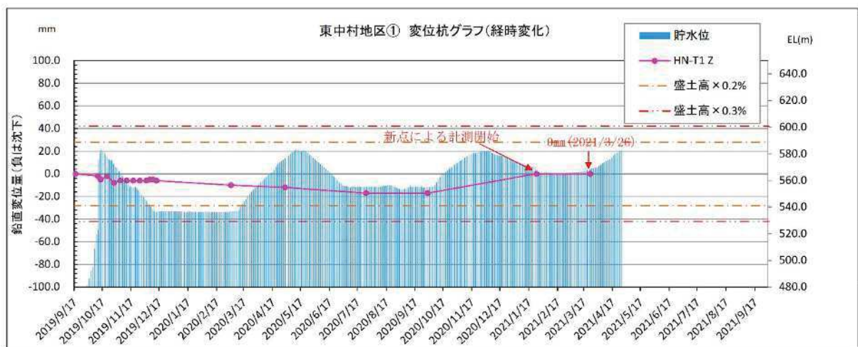
図 6.64 変位杭 HN-T1 変動図
