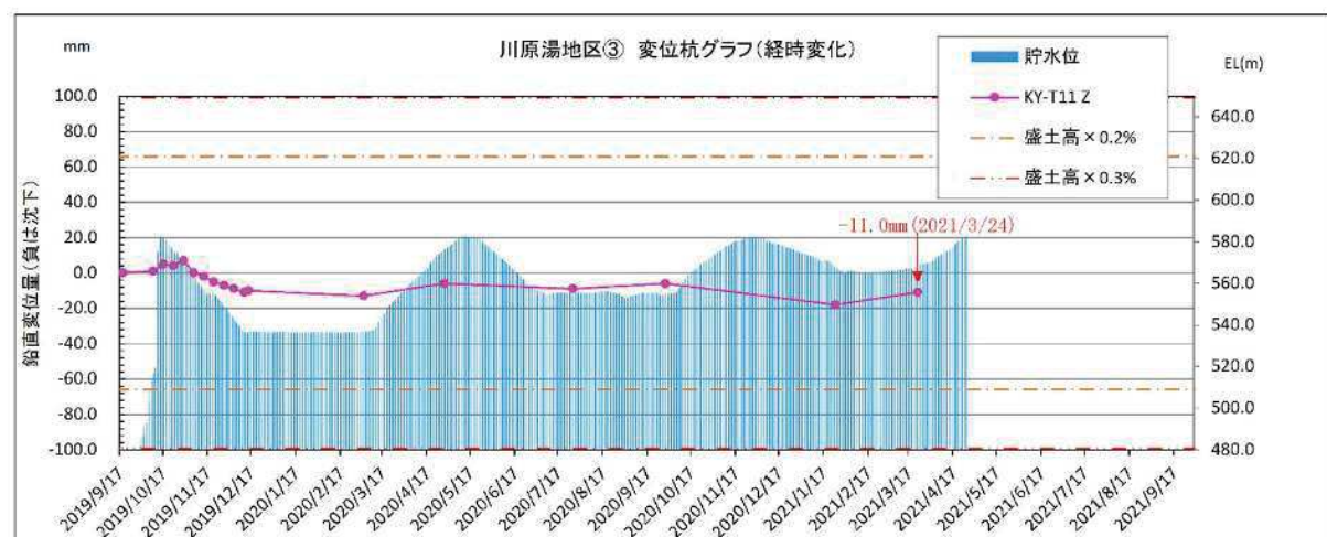
図 6.29 変位杭 KY-T11 変動図
