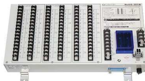
図 2.12 データロガ (NetLG-301N) の仕様及び外観
