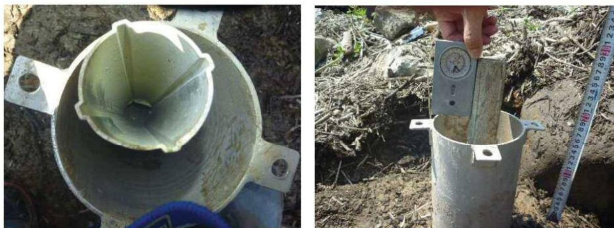
図 10.3 ガイド管の変形状況
