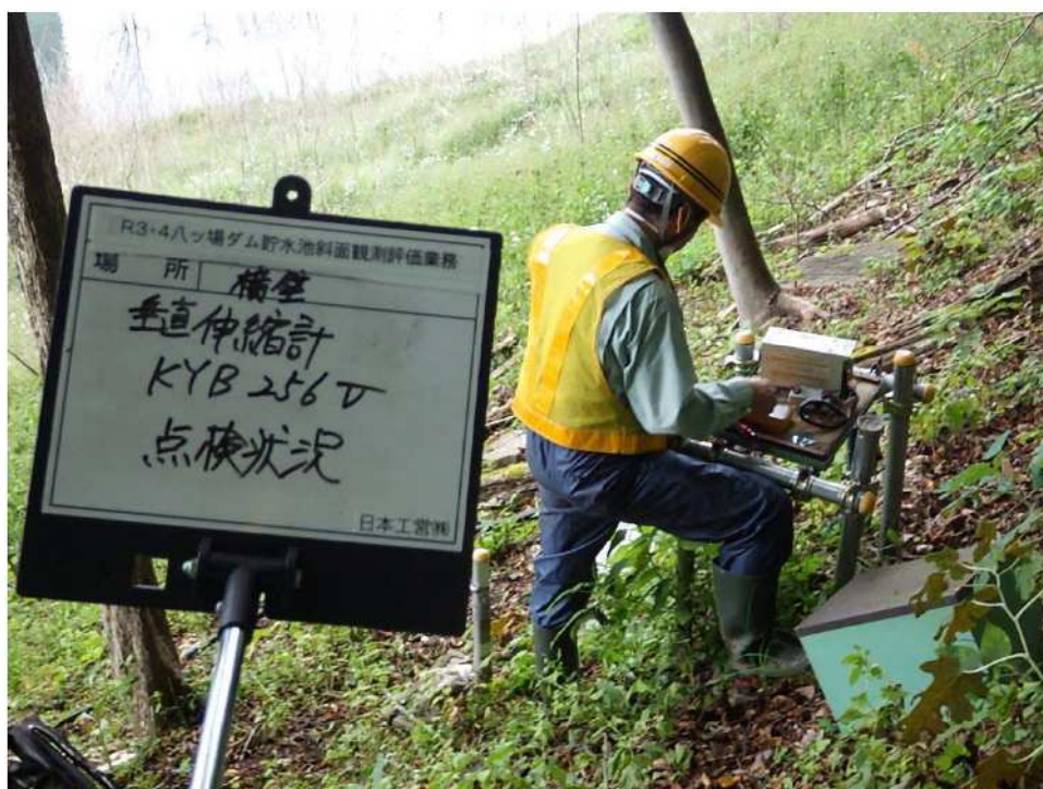
写真 13.6 垂直伸縮計 点検実施状況
